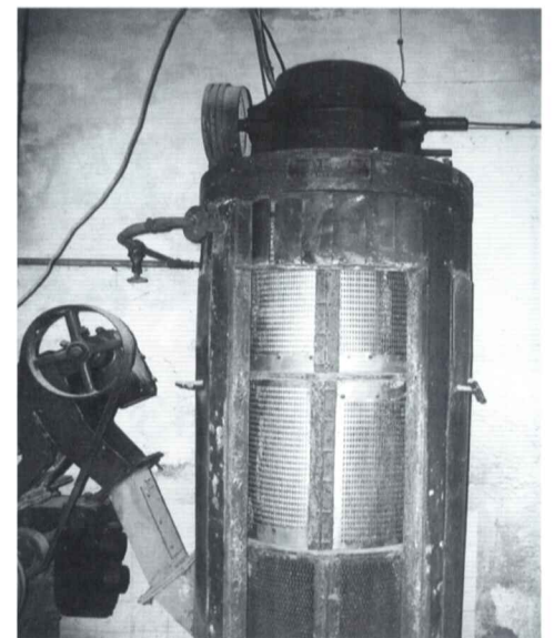
"Columna Secadora". A esta máquina le entra el trigo mojado de la rosca lavadora
